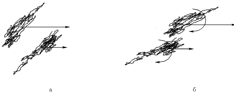
Рис. 3.24. Полимерные цепи в сдвиговом течении деформируются вдоль главных осей тензора скоростей деформации \mathbf{D} (а), ориентированных под углом 45^\circ относительно плоскостей сдвигающихся пластинок, и поворачиваются в результате взаимодействия друг с другом в процессе течения (б). Тензоры \mathbf{D} и \mathbf{T} несоосны
